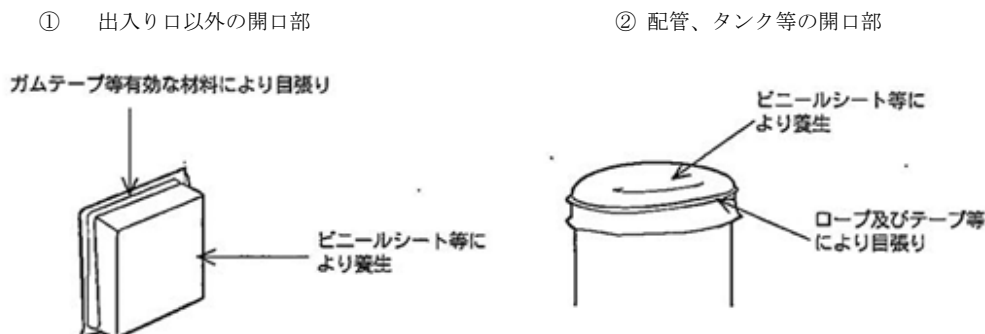
図 4-4 設備開口部の養生
